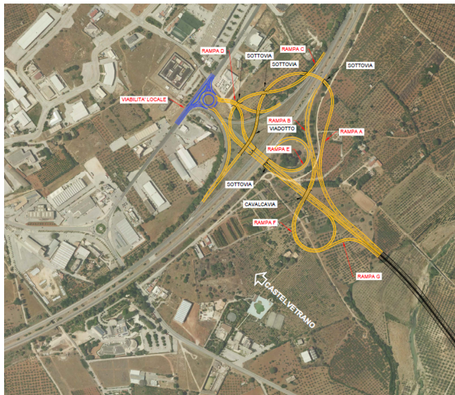
Nuova geometria dello Svincolo di Castelvetrano
